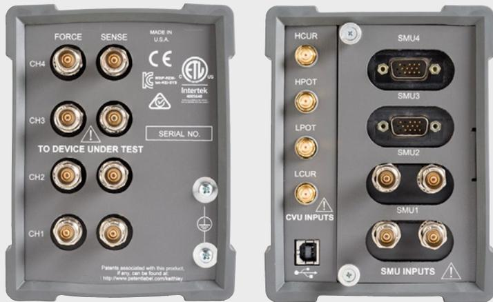
下面是 4200A-CVIV 多通道开关的外部连接。C-V 测量可以移到任何输出通道上，而不需重新布线。用户可以配置每条通道，使用 4200-PA 预放进行低电流测量，或使用 SMU 直传 4200A-CVIV-SPT 实现标准电流分辨率。4200A-CVIV 通过 USB 电缆从 4200A-SCS 主机供电。
