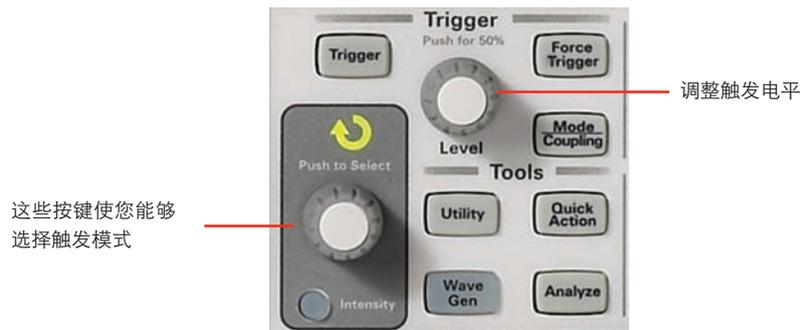
图 20. Keysight InfiniiVision 2000 X 系列示波器前面板上的触发控制区域
