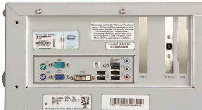
图 9. Keysight Infiniium 9000 系列示波器的后面板
