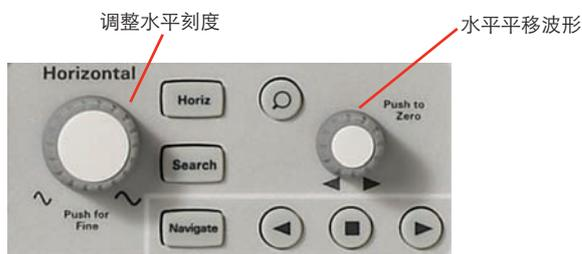
图 17. Keysight InfiniiVision 2000 X 系列示波器前面板上的水平控制区域
