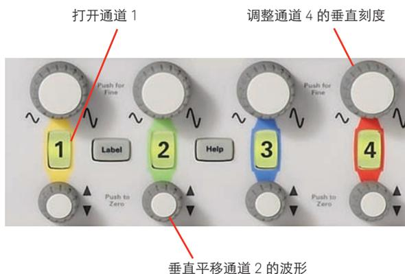
图 16. Keysight InfiniiVision 2000 X 系列示波器前面板上的垂直控制区域
