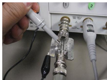
图 2-2. 由长接地引线引起的探头负载
