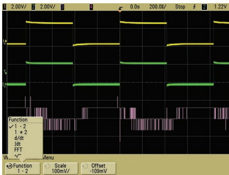
图 5-2. 明智的检查办法是对同一信号进行双重探测，再观察“A-B”结果如何显示。
