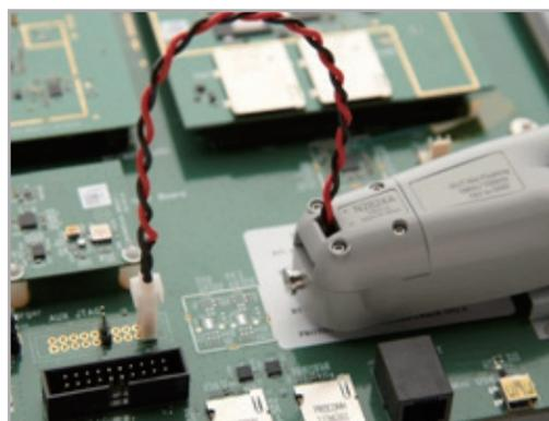
图 4-4. 它附带的先通后断（MBB）连接器使您无需焊接或拆焊引线，即可快速地探测被测器件上的多个位置。
