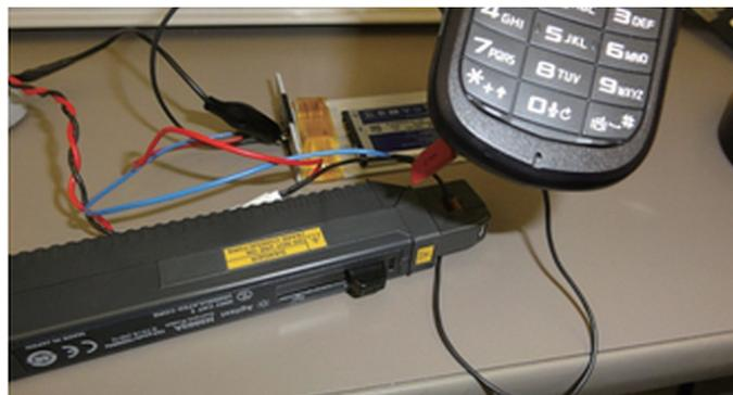
图 4-2. 使用示波器测量电流的最简单方法是使用钳形电流探头，例如 Keysight 1147B 或 N2893A。
