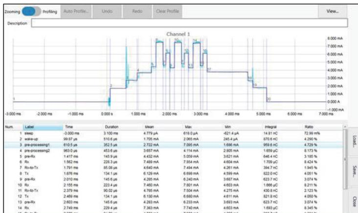
图 10. 自动功率和电流剖面仪
