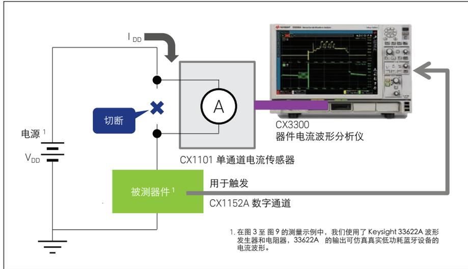
图 1. 测量低功耗蓝牙设备 I<sub>DD</sub> 电流的电路系统方块图
