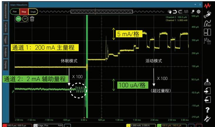
图 9. 使用 CX1102A 双通道电流传感器测量电流曲线的示例
