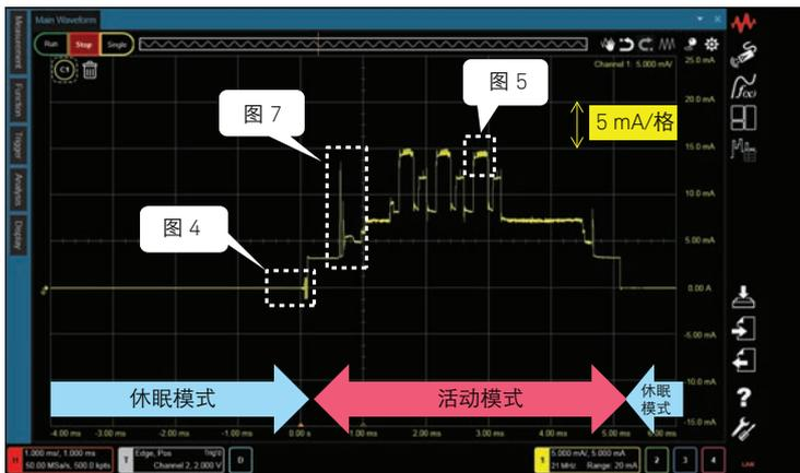
图 3. 广播事件的电流曲线测量示例
