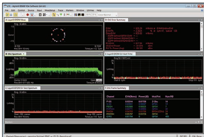
图 7. 使用 89600 矢量信号分析仪软件分析频谱测量结果(上), 生成各种有用的迹线, 包括误差汇总(下屏, 右上迹线)。它显示出 LTE 信号的 EVM 为 0.6%。
